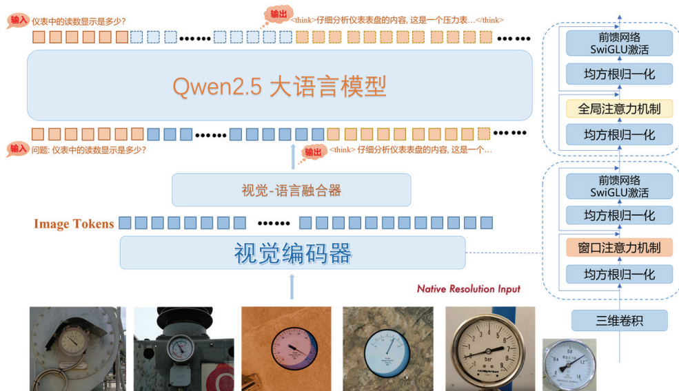
图 1 Qwen2.5-VL [19] 框架中的视觉编码器与语言模型解码器
